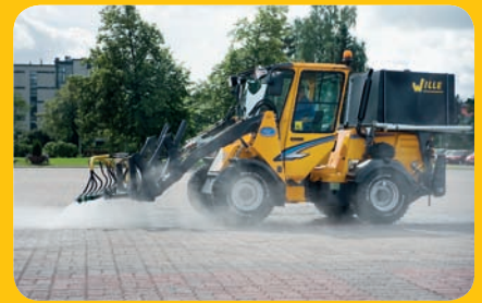
Réservoir d'eau pour lavage haute-pression
