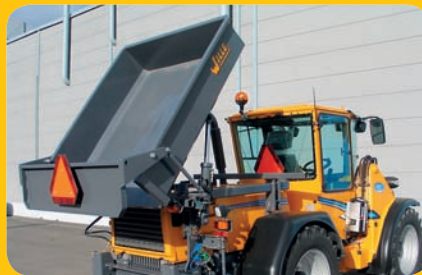
Réservoir sur plateforme hydraulique
